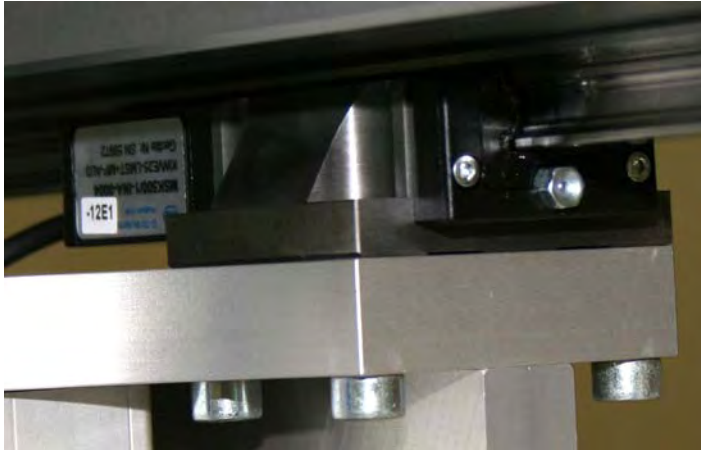
Abbildung 3.8: Detail Kugelumlaufeinheit mit Schmiernippel
