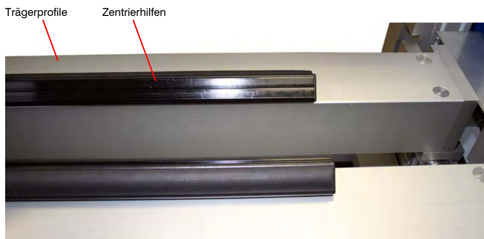
Abbildung 3.2: Targetauflage mit Zentrierung
